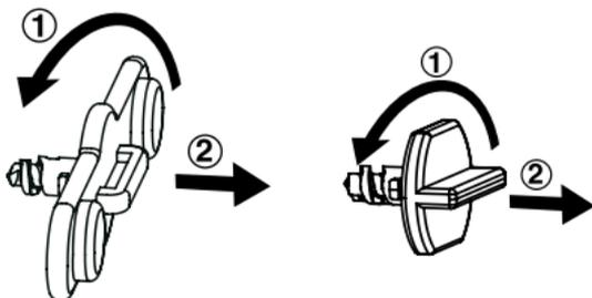
① Drehen Sie die Transportsicherung entgegen dem Uhrzeigersinn.
