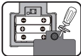
4. Setzen Sie 3 neue AA-Batterien (AM-3/LR6) ein. Für eine optimale Leistung werden neue Alkali-Mangan-Batterien oder vollständig geladene wiederaufladbare Ni-MH-Batterien empfohlen.
