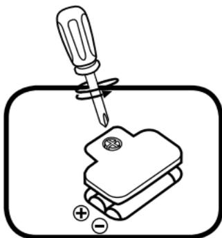
2. Setzen Sie 2 neue AAA (LR03/AM-4) Batterien, wie auf dem Bild im Inneren des Batteriefaches dargestellt, ein. (Für eine maximale Leistung wird das Verwenden neuer Batterien empfohlen).
