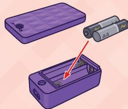
**2** Zwei AA-Batterien einlegen und die Schraube des Deckels mit einem Schraubenzieher festziehen.
