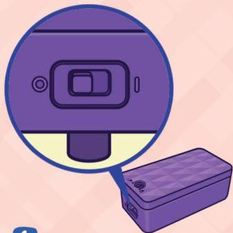
**1** Schalter des Batteriefachs auf die AUS-Position schieben.
