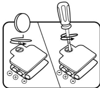
3. Entnehmen Sie gegebenenfalls ältere Batterien, indem Sie auf eine Seite der Batterie drücken.
