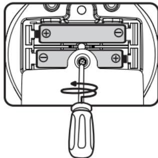
4. Setzen Sie 2 neue AAA-Batterien (LR03/AM-4) ein, wie auf dem Bild im Inneren des Batteriefaches dargestellt. Achten Sie dabei auf die richtige Polung. Für maximale Leistung wird die Verwendung neuer Alkali-Mangan-Batterien oder vollständig aufgeladener Ni-MH-Batterien empfohlen.
