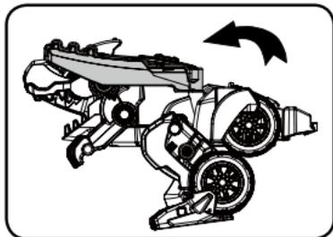
2. Drehen Sie die beiden Teile des Schwanzes um 180° zum Kopf.
