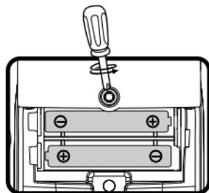
4. Setzen Sie 2 neue AAA (LR03/AM-4) Batterien ein. Für eine optimale Leistung werden neue Alkali-Mangan-Batterien oder vollständig geladene wiederaufladbare Ni-MH-Batterien empfohlen.
