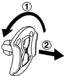
① Drehen Sie die Transportsicherung entgegen dem Uhrzeigersinn.
